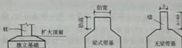
图 11-3 现浇混凝土基础
